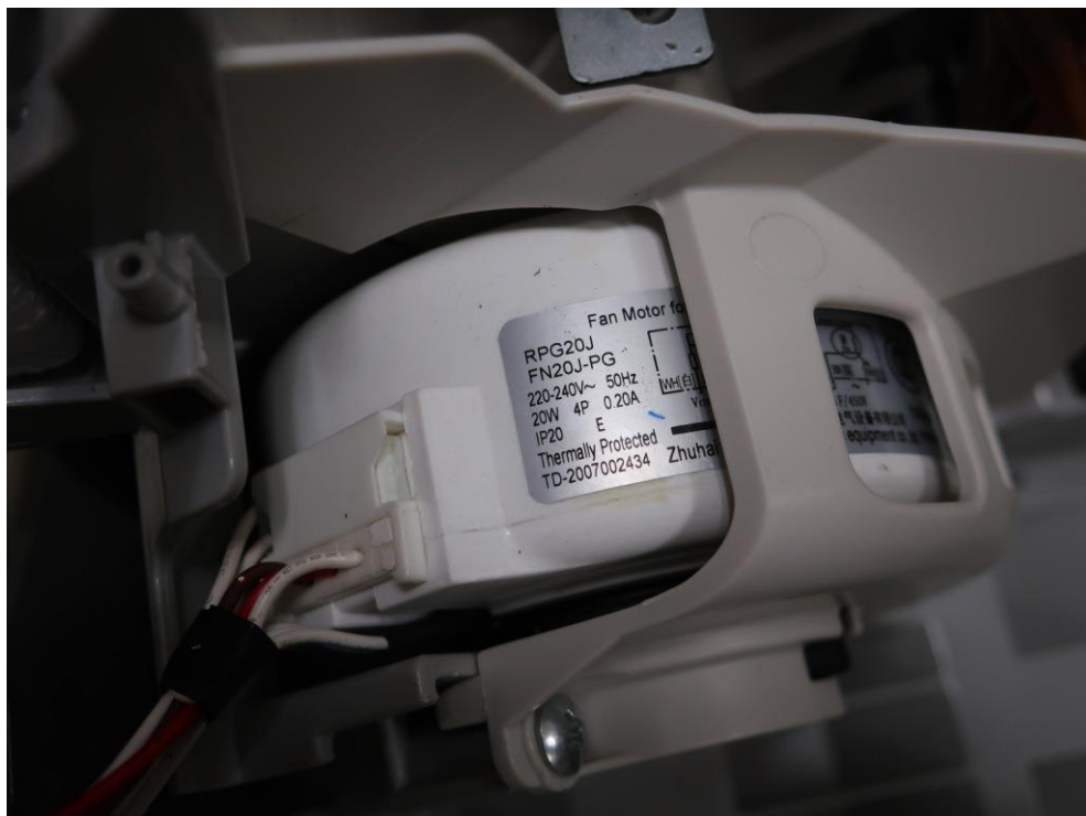
Fan motor marking
